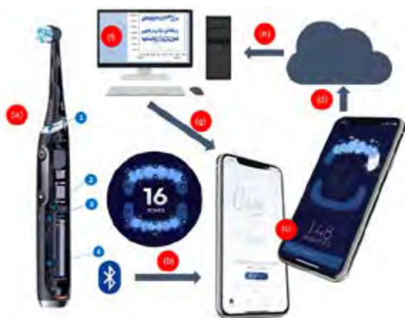
Figure 1. Schéma de l'architecture du dispositif testé : brosse à dents connectée multi-capteurs (mouvement, gyroscope, pression), application smartphone de guidage en temps réel sur 16 zones de la denture, transmission des données au praticien et envoi de micromessages ciblés. Cette illustration provient de l'article original, publié dans le Journal of Clinical Periodontology du 17 avril 2024.
